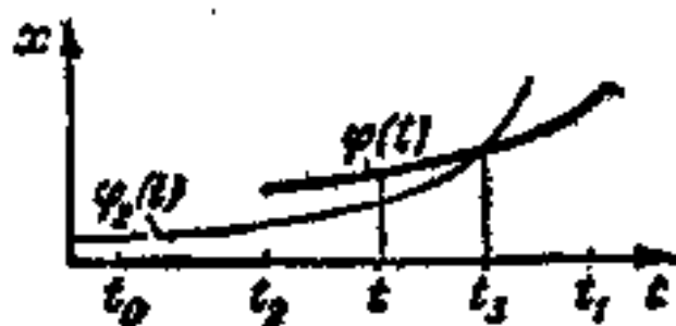
图 21 解 \varphi 不能等于零, 因为它比指数函数 \varphi_1 更慢地接近于零.
