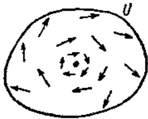
图 157 从平衡位置的充分小邻域内出发的相曲线停留在平衡位置附近吗？
